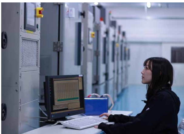
LiBの劣化状況を診断する様子
